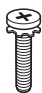
Wkręty podstawy 8Szt., M4 x L20 (Tylko modele UB83**-ZB) (Patrz str. A-4) 4Szt., M4 x L20 (Tylko modele UB80**, UB82**) (Patrz str. A-3)
