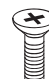
Wkręty podstawy 2Szt. M4 X L10 (Tylko modele UG88**) (Patrz str. A-8)
