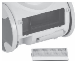
6. Zainstaluj nowy filtr HEPA i wsadź z powrotem osłonę.
